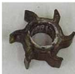
※劣化したインペラ
