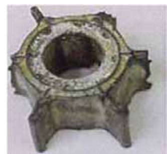
※破損したインペラ
