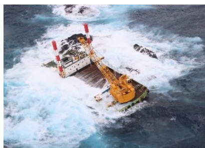
貨物船の船体亀裂
